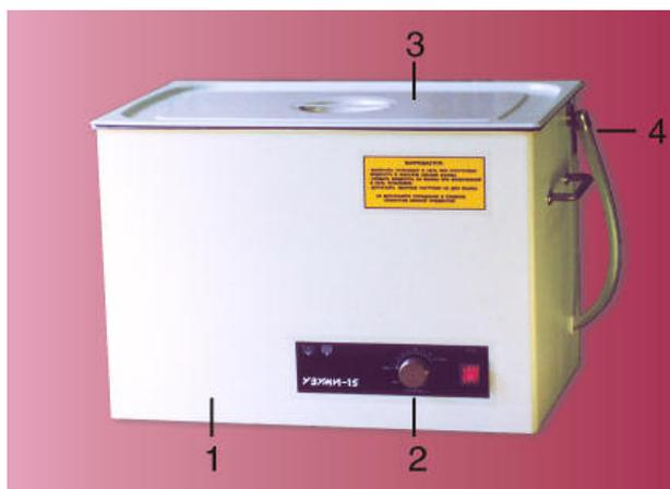
Рис. 1. Установка ультразвуковой мойки.
