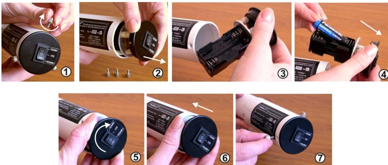
**Рис.6.** Порядок установки (замены) элементов питания
