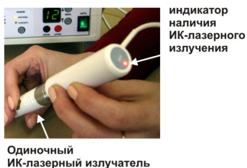
Рис.11. Проверка работы одиночного ИК-лазерного излучателя.
