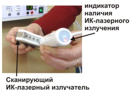
Рис.10. Проверка работы сканирующего ИК-лазерного излучателя.
