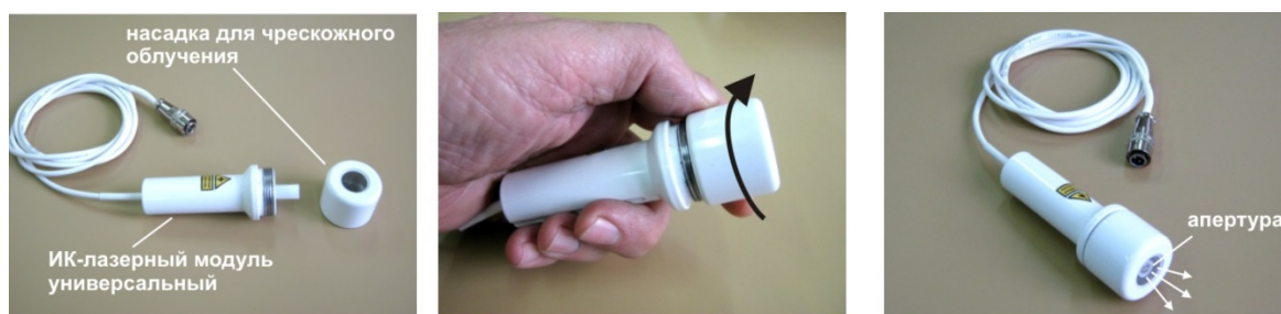
Рис.10. Установка насадки для чрескожного облучения.
