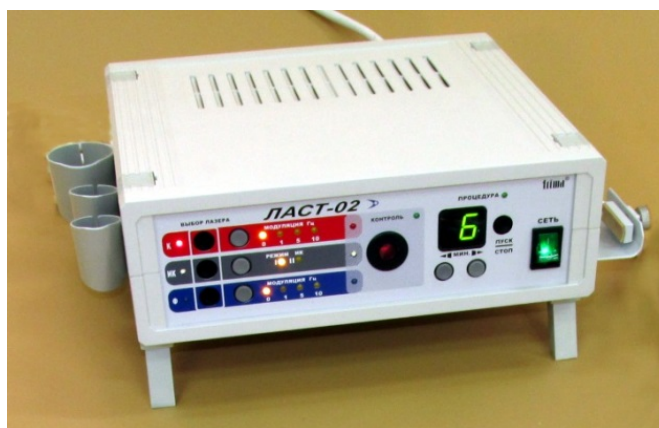
Рис.6. Установка передних ножек корпуса электронного блока в "рабочее" положение.
