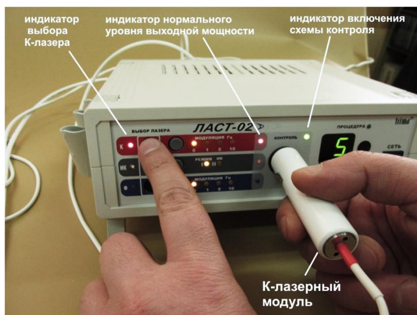
Рис.21. Проверка соответствия уровня выходной мощности К-лазерного модуля.
