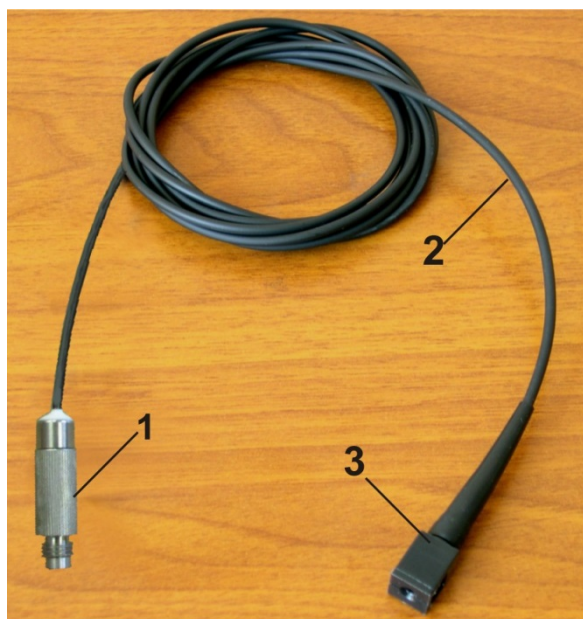
Рис.19. Магистральный световод для подключения световодных насадок ВЛОК.
