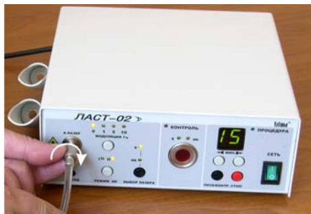
Рис.8. Подключение световода к выходному гнезду лазерного модуля аппарата.
