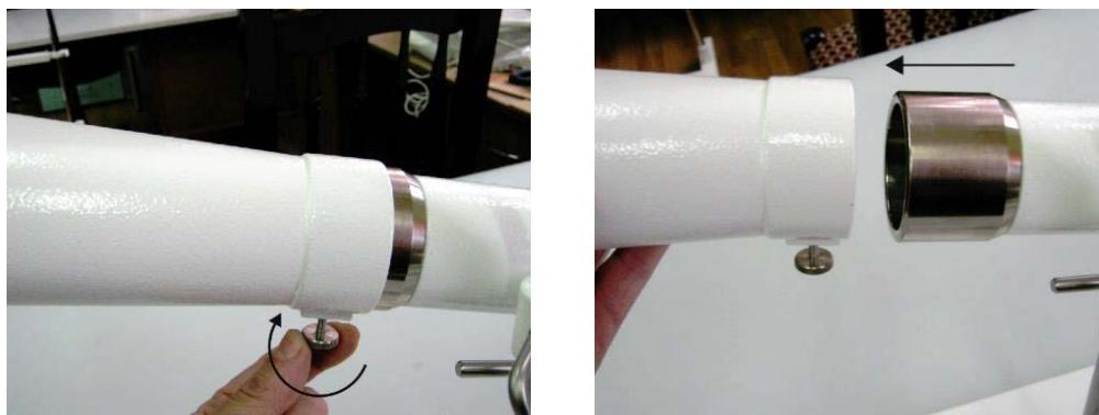
Рис. 6. Снятие тубуса с блока формирования спекл-поля.
