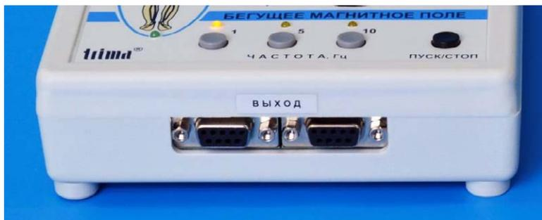
Рис. 3. Расположение выходных разъёмов для подключения излучателей бегущего магнитного поля.
