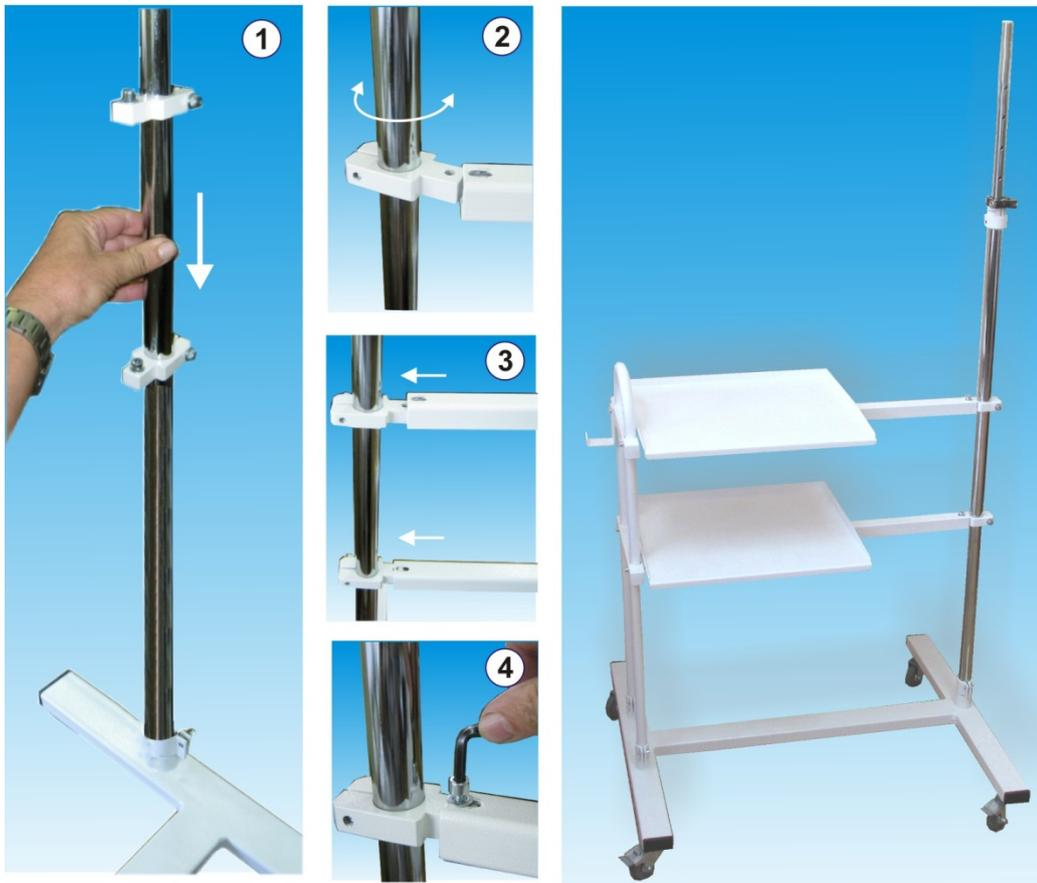
Рис.12. Установка и фиксация основной стойки.
