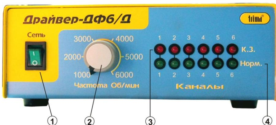
Рис.2. Передняя панель Драйвера "ДФ6/Д".
