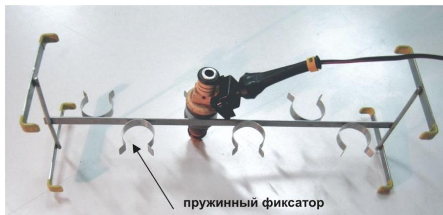
Рис.4. Расположение форсунки в фиксаторе оправки.
