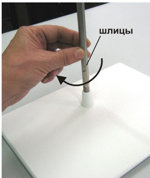
Рис.5. Установка стойки в основание.
