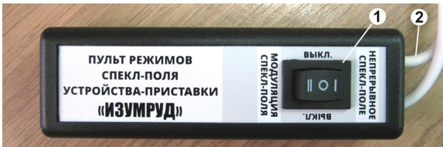
Рис.2. Пульт управления режимами устройства-приставки "ИЗУМРУД".
