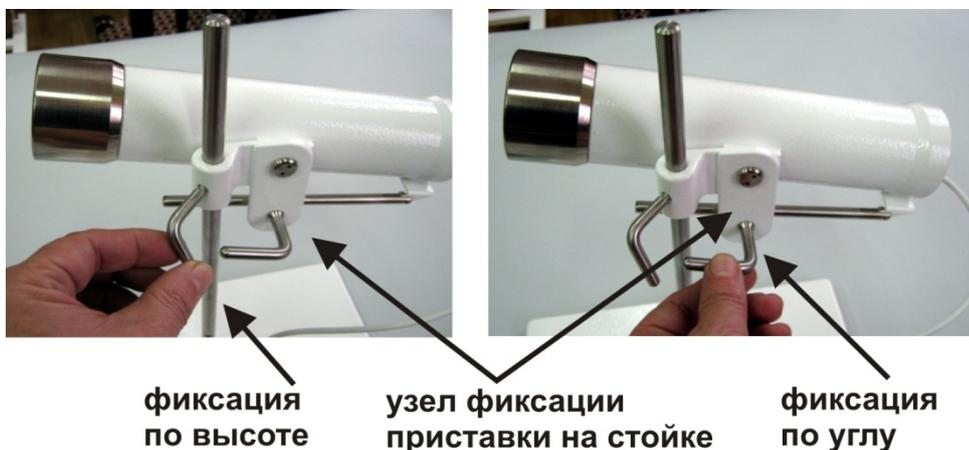
Рис.6. Установка устройства-приставки на стойку и его фиксация по высоте и углу.
